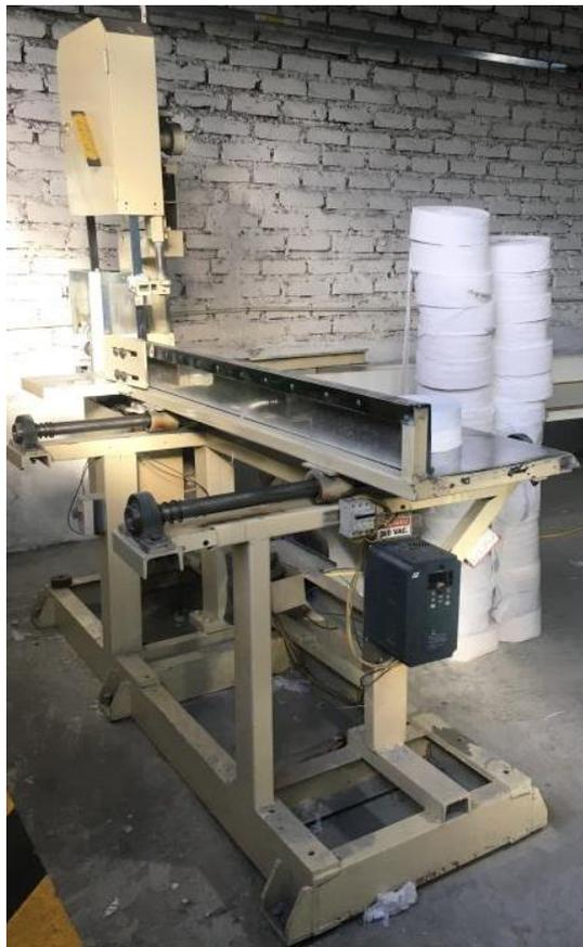
Figura 3.10: Máquina cortadora tamaño jumbo
