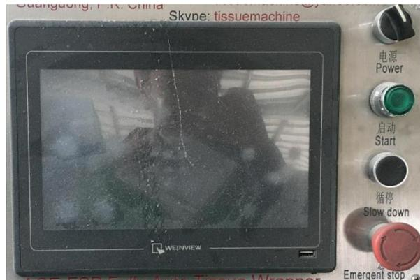
Figura 3.9: Panel de operación de empacadora
