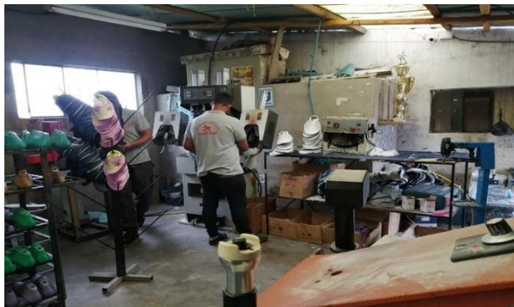
**Figura 3.15.** Área de pegado de punteras, taloneras, empastado y emplantillado
