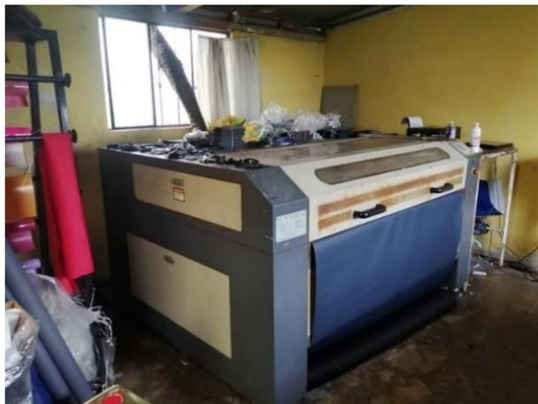
**Figura 3.12.** Máquina de cortado laser
