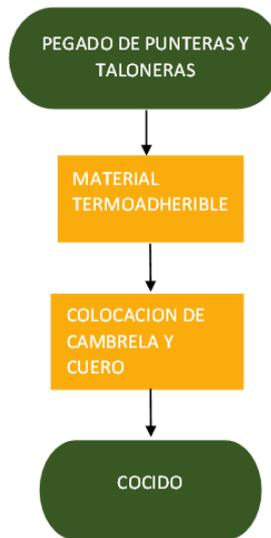
**Figura 3.27.** Diagrama de flujo proceso de pegado de punteras y taloneras
