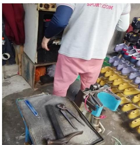
**Figura 3.5.** Proceso de armado o jaleado 1/3
