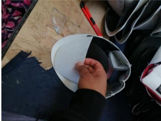
**Figura 3.13.** Colocación de la puntera (material termo adherible) en el corte
