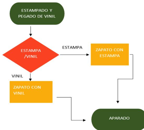
**Figura 3.24.** Diagrama de flujo proceso de estampado y pegado de vinil
