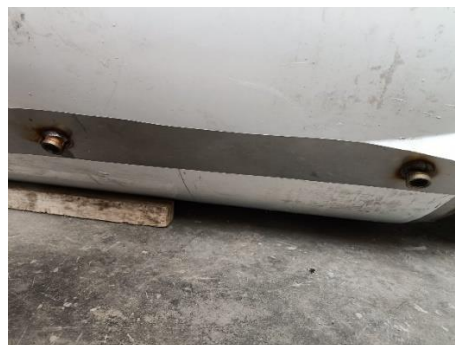
Perforado y colocado de salidas, entradas del líquido y visor.
