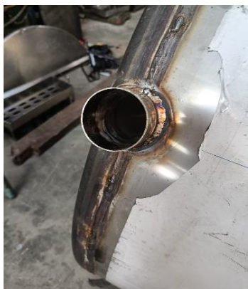
Soldadura del desfogue de la leche.
