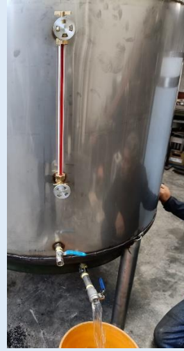
Colocación de visor y válvulas para la primera prueba
