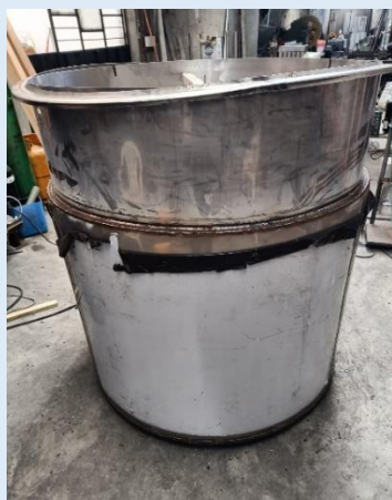
Colocación del anillo de soporte de la lana de vidrio
