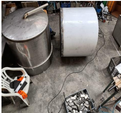
Soldadura del segundo tanque interno y colocación del desfogue de la leche
