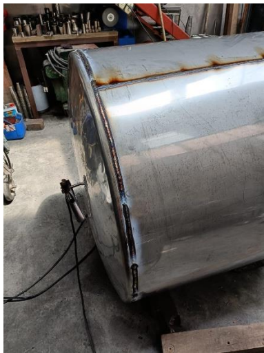
Soldadura exterior con cordón
