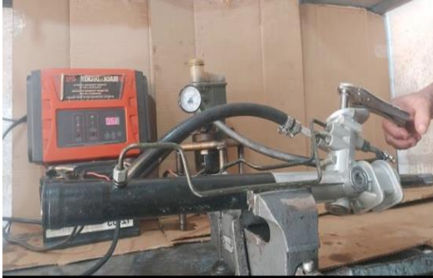
Figura 3.16: Prueba e sistema de dirección hidráulica
