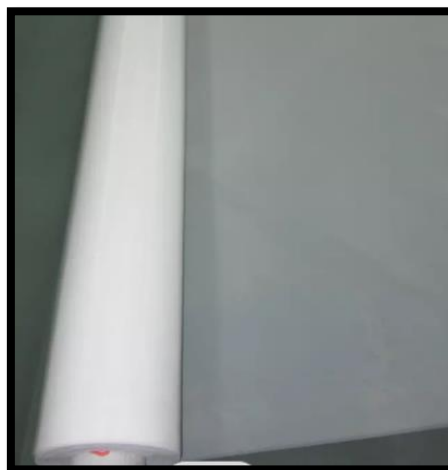
Figura 3.24: Malla de nylon para tamizar. [44]
