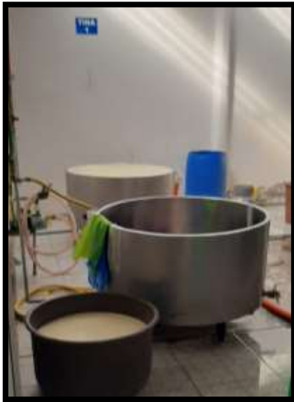
Tinas de Pasteurización
