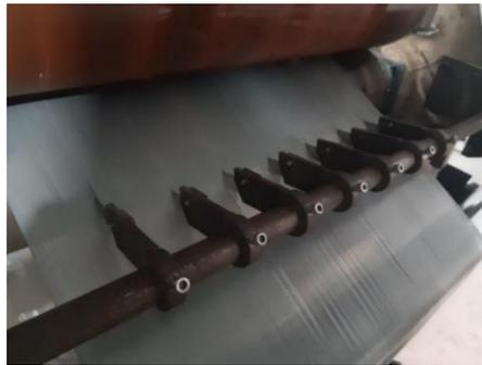
Figura 14: Lámina pasando por las cuchillas para formar cintas.
