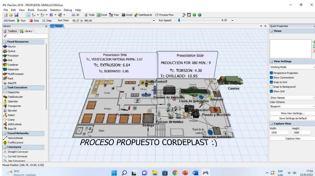
Figura 53: Software FlexSim valores de los Tc propuesto.
