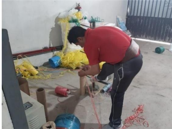
Figura 18: Colocación de la cinta en la retorcedora.
