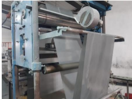
Figura 13: Lámina pasando por los rodillos.
