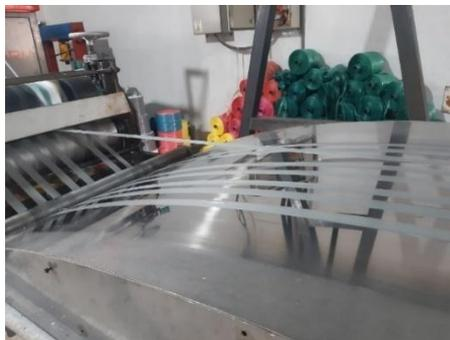
Figura 15: Recorrido de la cinta por la plancha de estiramiento.
