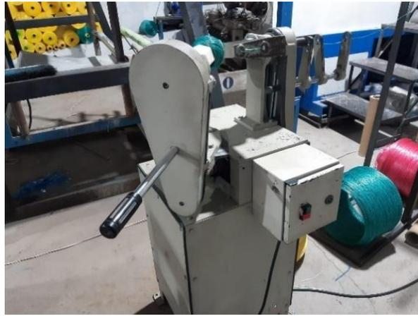
Figura 21: Máquina ovilladora.
