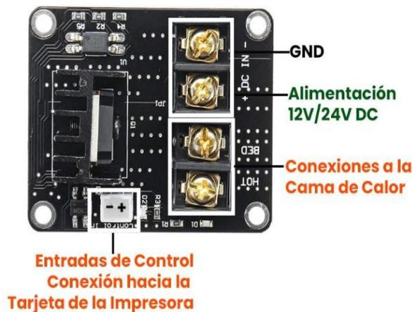
Figura 3.30: Módulo de Potencia Mosfet 210a [48]
