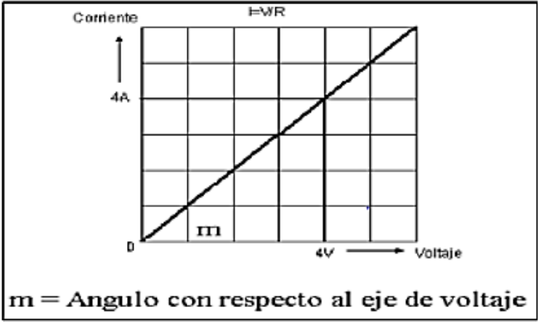
Figura 2.6: Curva del comportamiento de una carga lineal
