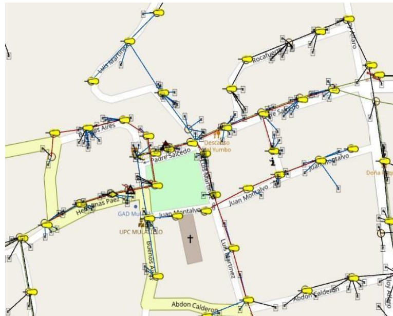
Figura 5.20. Distribución de las cargas del transformador local
