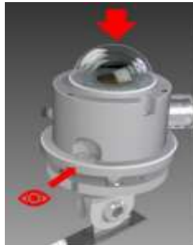
Figura 4.5: Montaje del sensor en el soporte.
