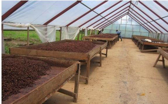
**Figura 3.13** Secado tipo túnel con camas levantadas [18].
