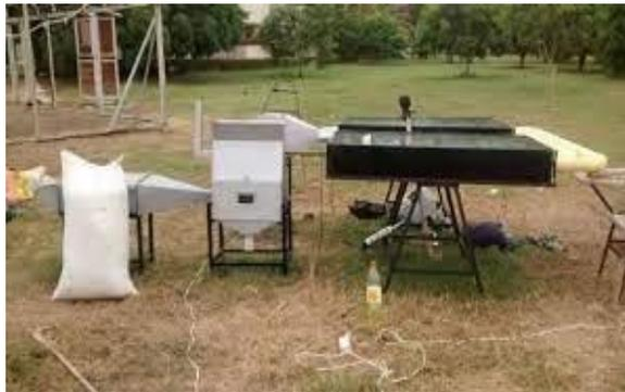
**Figura 3.19** Secado híbrido (GLP y energía solar) [25].
