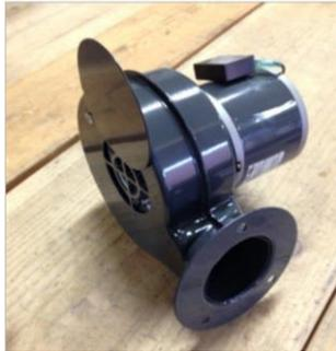
Soplador PSC, curva delantera, accionamiento directo, diámetro de la rueda de 3 pulgadas, CFM @ 0.000-in SP 50, voltaje 110-120,60 Hz, monofásico, amperios de carga completa 0.23, RPM 3036, temperatura máxima de entrada 104 grados F, altura total 5 13/16 pulgadas, ancho total 5 1/8 pulgadas, profundidad total 6 7/16 pulgadas, incluye brida de montaje de descarga y cubierta de entrada
