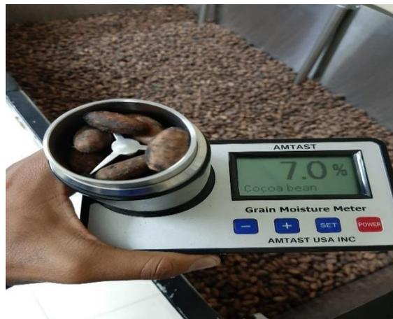
**Figura 5.16** Secado óptimo del cacao con 7% de humedad.
