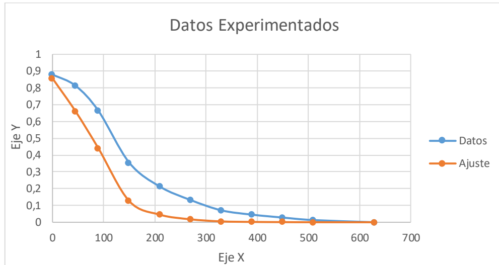
Figura 38 : Ajuste del diagrama utilizando la fórmula de Page de Cinética Cacao de CCN-51, de 60 °C
