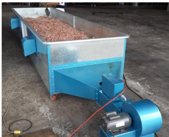
Figura 11 : Secado Artificial Gas Licuado De Petróleo (GLP) [23].
