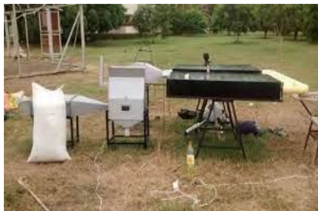
Figura 13 : Secado Híbrido (GLP y Energía solar) [25].
