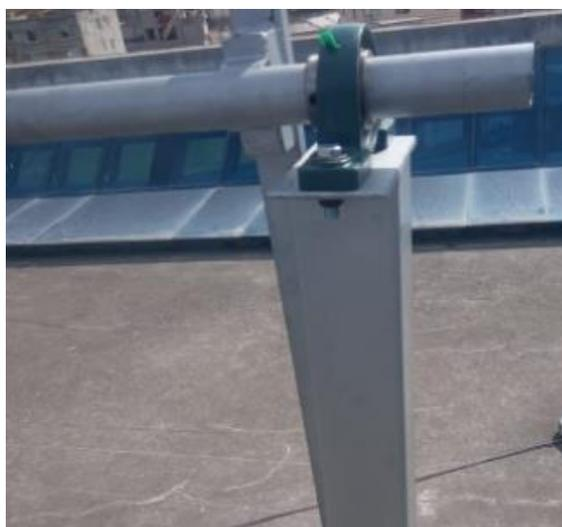
**Figura 5.27.** Montaje de rodamiento
