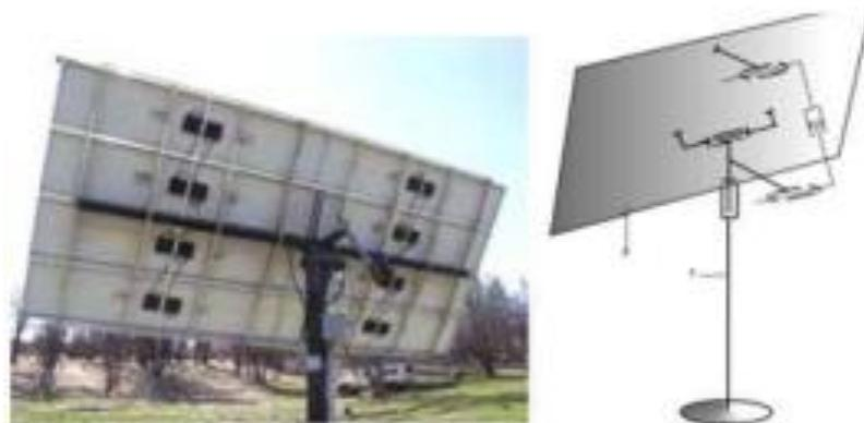
**Figura 3.8.** Estructura seguidora solar activo [17]
