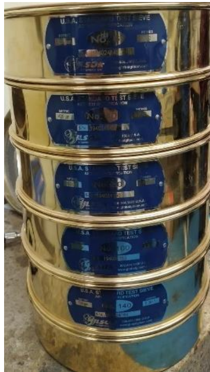
Figura 21: Tamices utilizados para el análisis granulométrico según norma ASTM E11 Tamiz #6, Tamiz #12, Tamiz #40, Tamiz #50, Tamiz #100, Tamiz #140, Tamiz #200.
