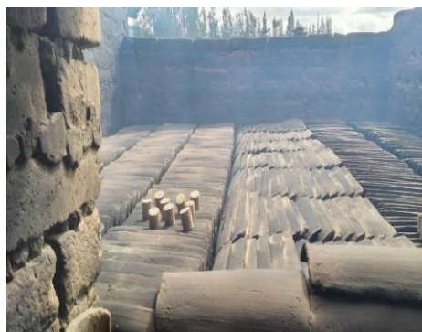
Fotografía 8. Quemado de probetas
