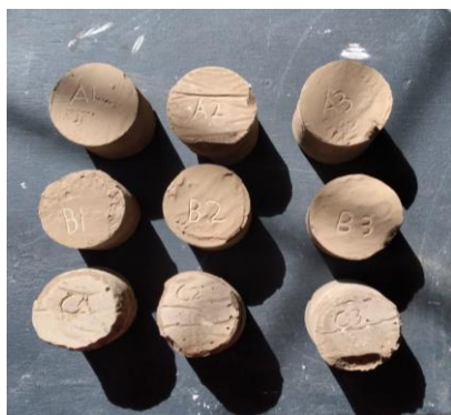
Fotografía C7. Probetas en proceso de secado
