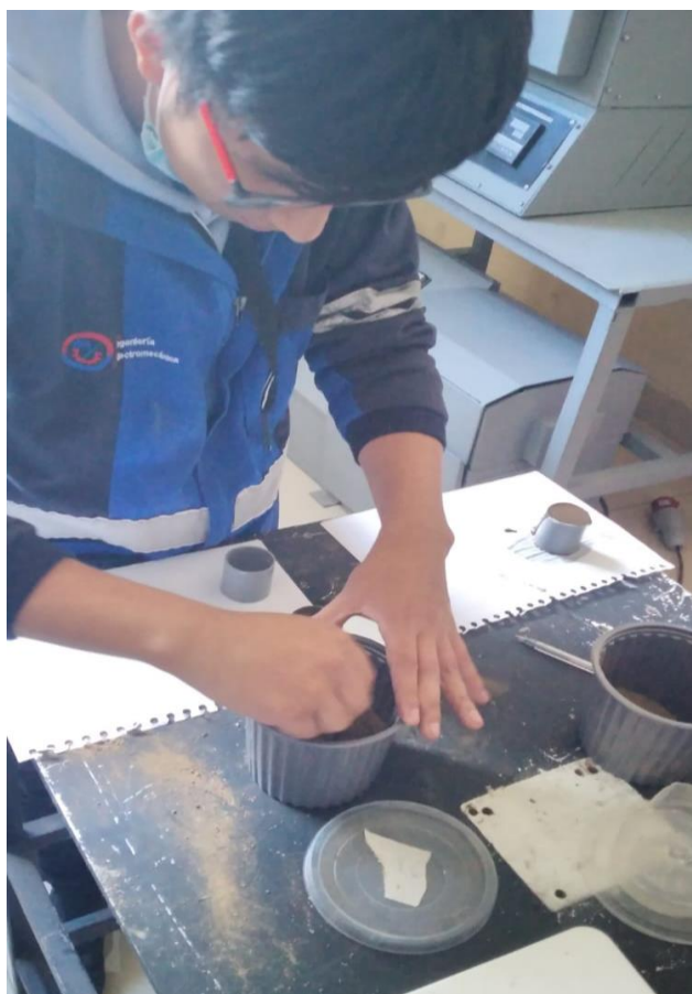
Figura 33: Mezcla de los materiales de acuerdo a los porcentajes pesados para su elaboración de probetas.
