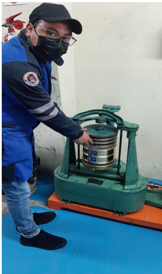
Figura 22: Selección de la máquina tamizadora.
