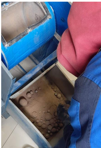
Figura 20: Obtención de la arcilla triturada en el molino de bolas.
