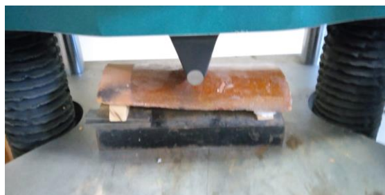
Fotografía C12. Prueba de resistencia de teja con agregado de vidrio
