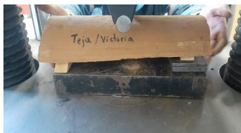
Fotografía C13. prueba de resistencia de teja de la victoria
