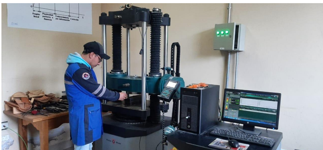
Figura 35: Ensayo a compresión de probetas de arcilla
