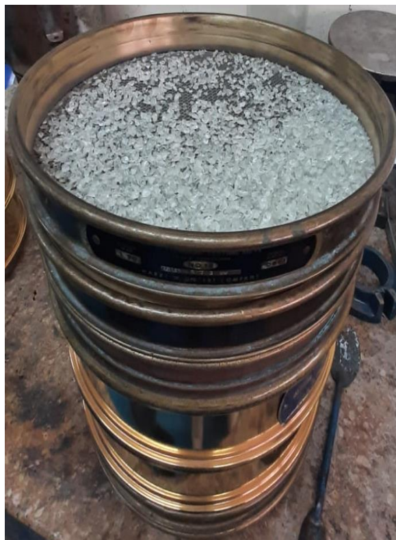
Figura 24: Granulometría del vidrio molido mediante el proceso de tamizado.
