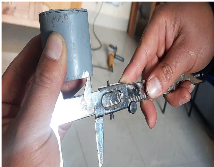
Figura 28: Acondicionamiento del tubo PVC para elaboración de las probetas
