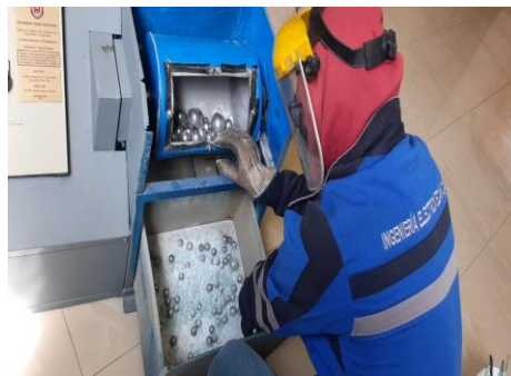
Fotografía C2: Vidrio triturado en el molino de bolas
