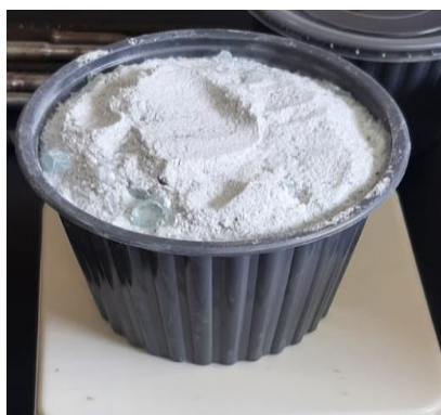
Fotografía C3. Obtención del vidrio triturado en el molino de bolas
