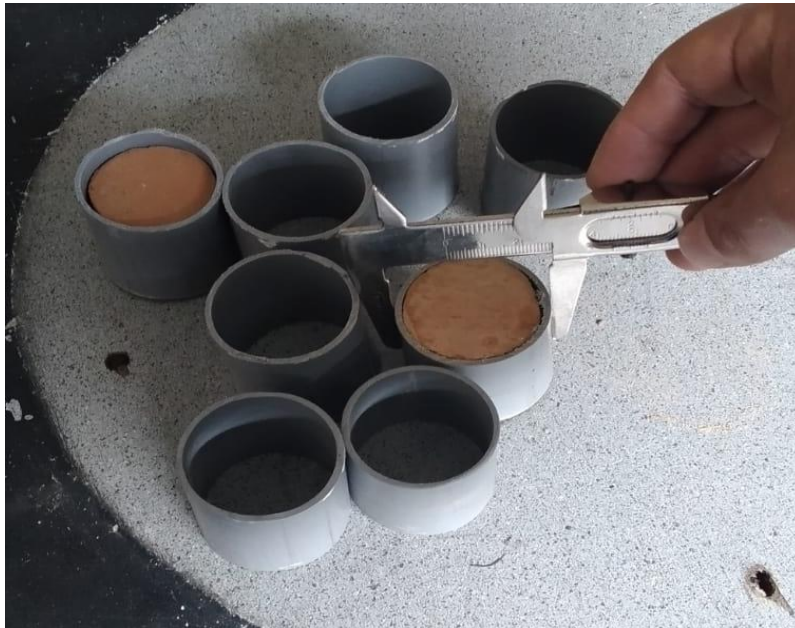
Figura 29: Verificación de medidas de los moldes para las probetas
