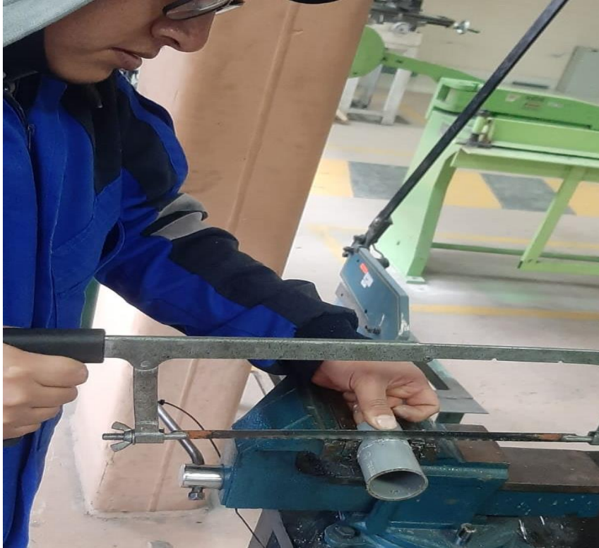
Figura 27: Corte a medida de los moldes para elaboración de probetas
