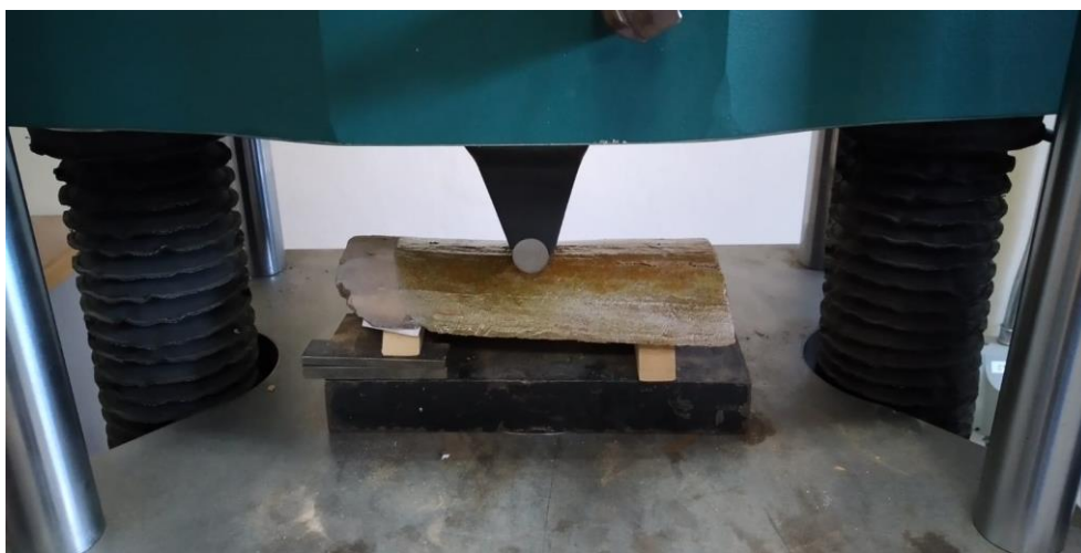
Figura 5: Disposición de la fuerza de ensayos a flexión
