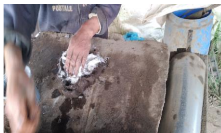
Fotografía C10. Elaboración de teja con mezcla de arcilla y polvo de vidrio
