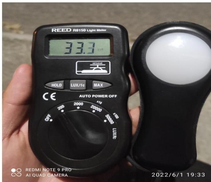
**Figura 4. 5.** Medición con el Luxómetro.
