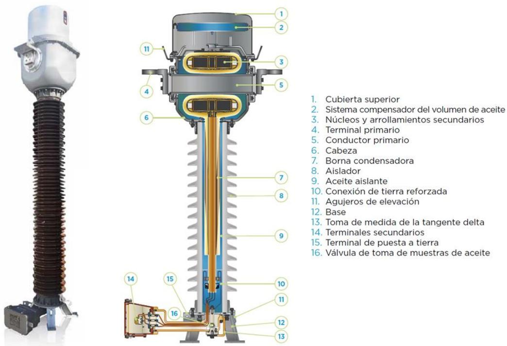
**Figura 2** Transformador de corriente [11]
