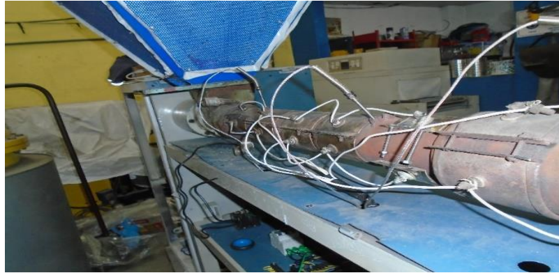
Figura 1.6 Fundición del plástico por resistencias calefactoras
