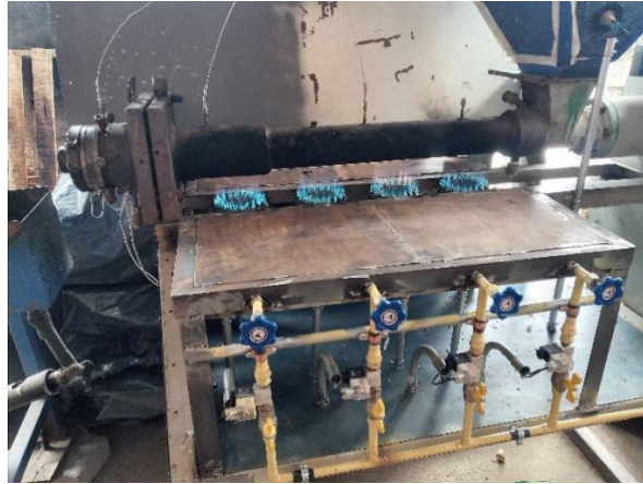
Figura 2.9 Zonas de temperatura de la máquina extrusora N. 2
