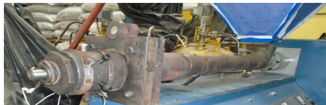
Figura 2.2 División de las zonas de calefacción en la máquina extrusora N. 1
