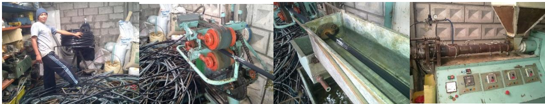
Figura 1.13 Proceso de extrusión con material reciclado
