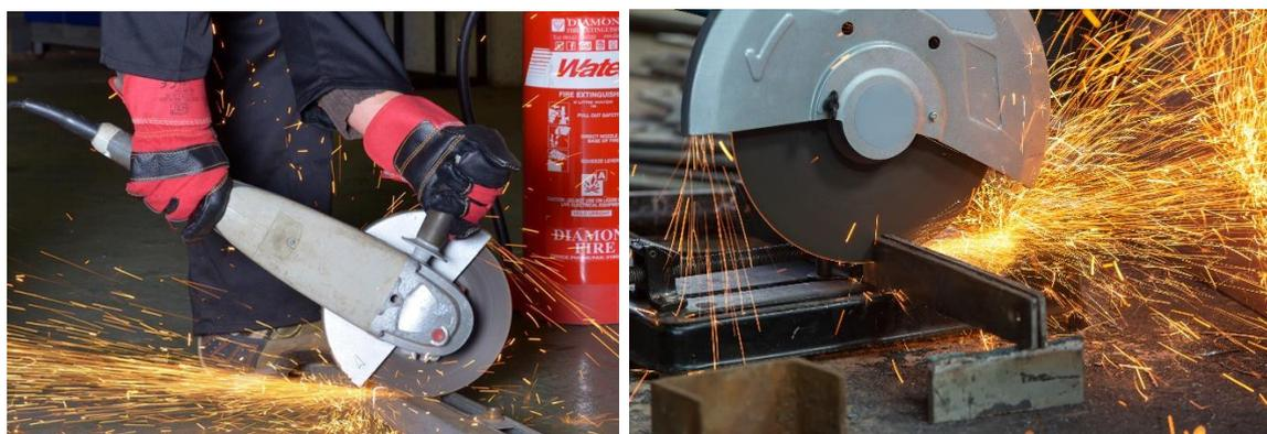
Los equipos de corte oxígeno – acetileno (llamados sistemas de oxicorte) cortadores de plasma, soldadoras de arco eléctrico en sus diversas variantes manejan altas temperaturas que pueden derivar en incendios.
