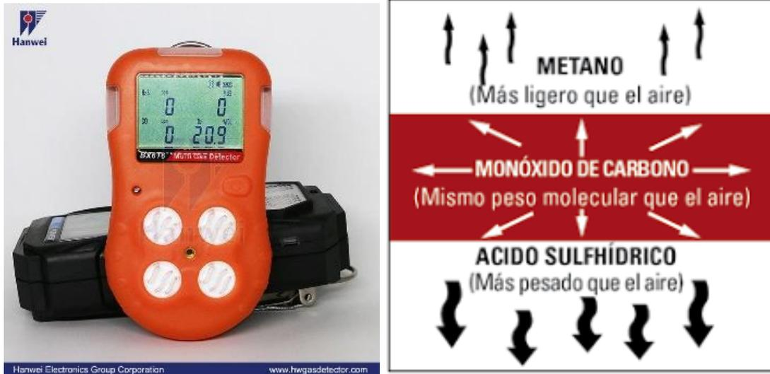
Para las mediciones de atmosfera dentro del espacio confinado se debe muestrear a diferentes niveles de altura. No se confíe con mediciones solo en la boca de entrada o en el manhole (compuerta de acceso) del espacio confinado.
