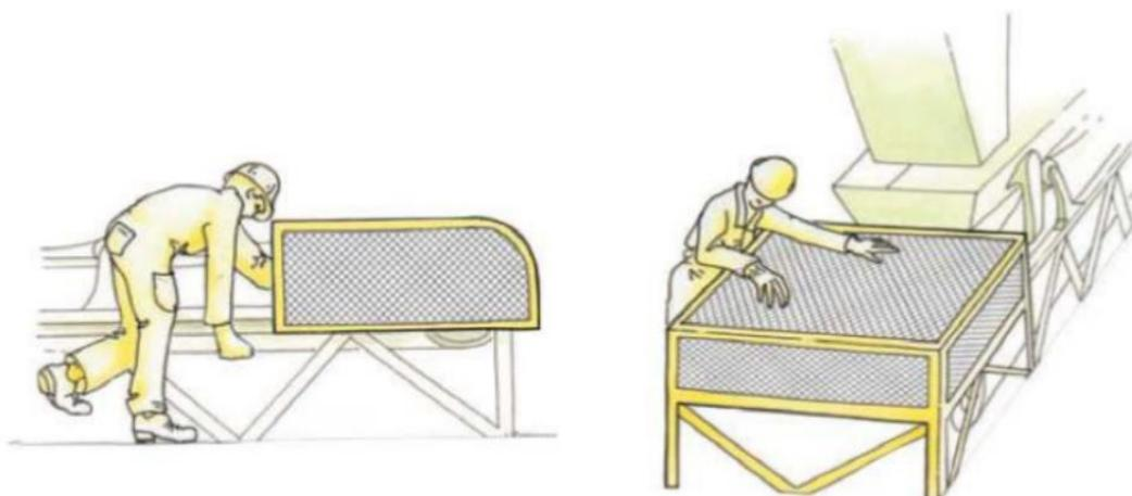
Las guardas de máquinas son aplicaciones de ingeniería que permiten una operación segura para el trabajo.
