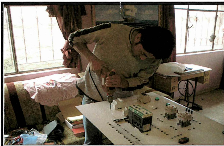
FIGURA 34 PERFORACIÓN Y UBICACIÓN DE PLUPS
