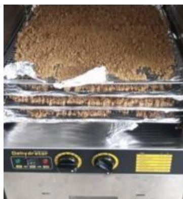
Figura 20. Secado en el deshidratador de la quinua
