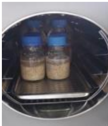
Figura 19. Precocción quinua mediante autoclave
