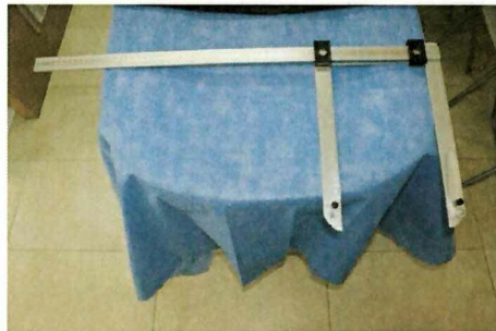
LIBRE GRANDE PARA DIÁMETROS ÓSEOS Medición de anchuras
