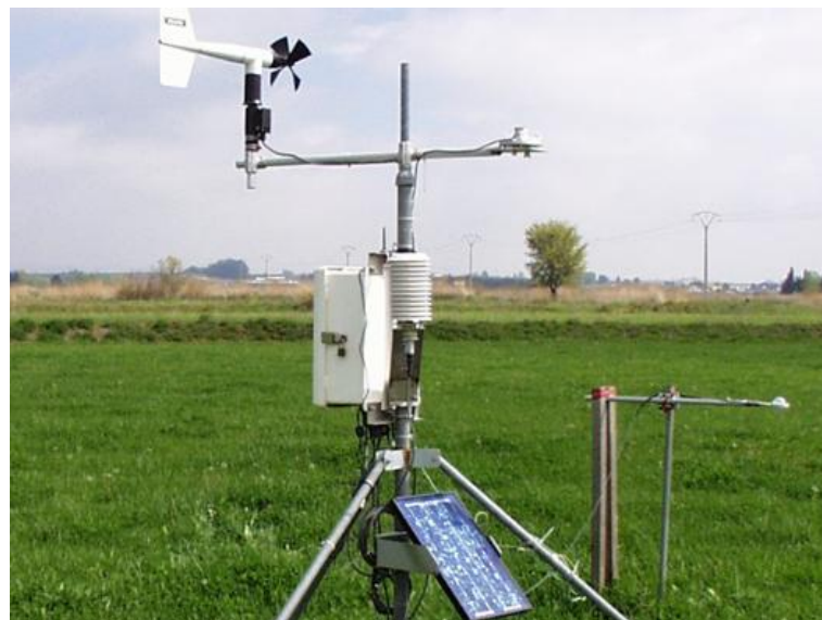
Figura 2. Estación meteorológica automática [10]
