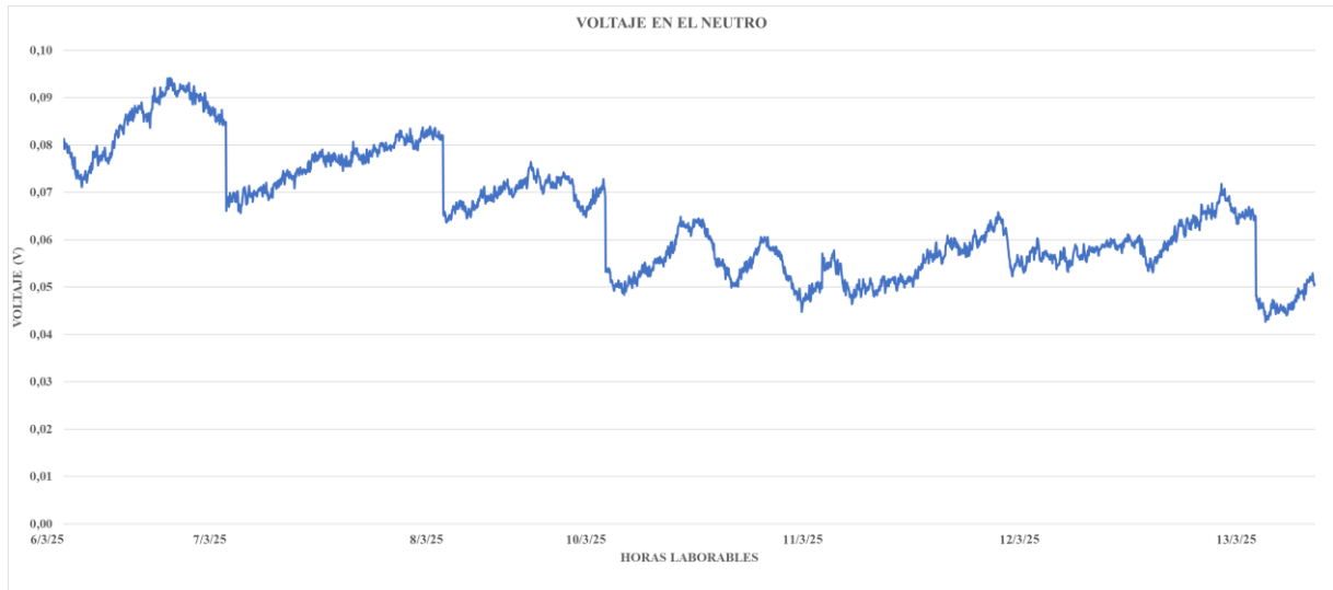
Figura 5.15 Voltaje en el Neutro en Horas Laborables TRAF0 750kVA.
