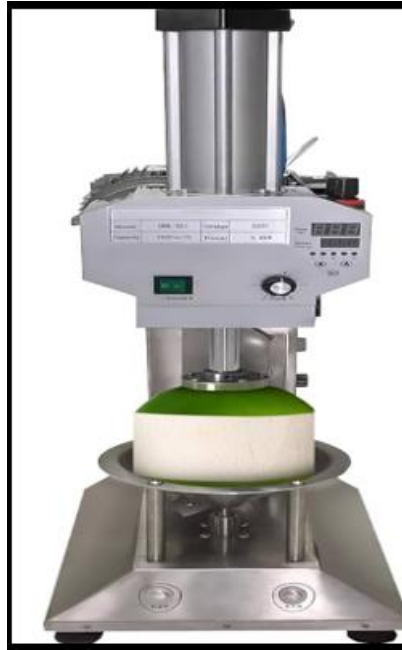
Figura 3-4: Prensadora de coco
