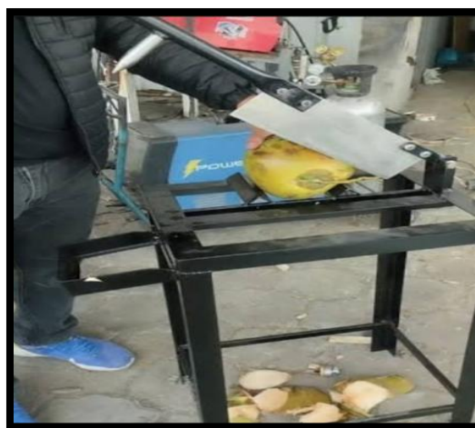
Figura 3-3: Guillotina manual para el pelado de cocos
