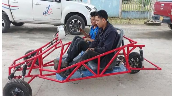
Figura 5. Prototipo del bugui eléctrico triciclo durante la fase de pruebas de construcción.
