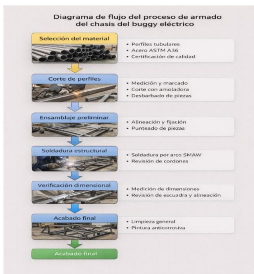
Figura 7. Diagrama de flujo del proceso de armado del chasis del buggy eléctrico.
