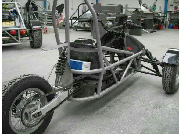
Figura 1. Chasis tubular de vehículo tipo bugui eléctrico triciclo.[4]
