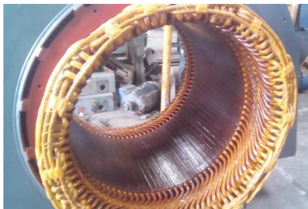
Figura 20. Estator con buen nivel de aislamiento 3132 MΩ
