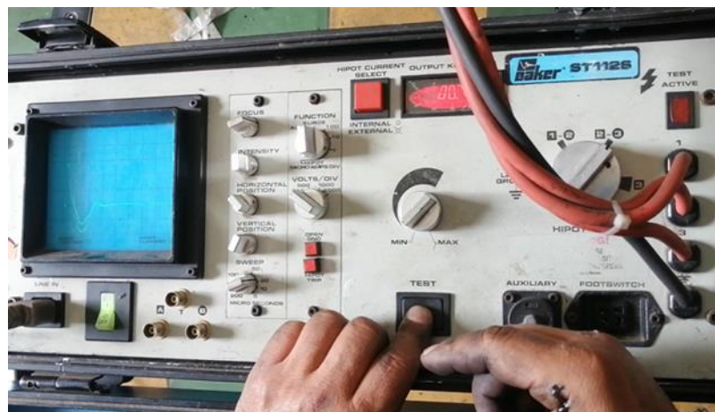
Figura 16. Toma de lecturas en el estator.
