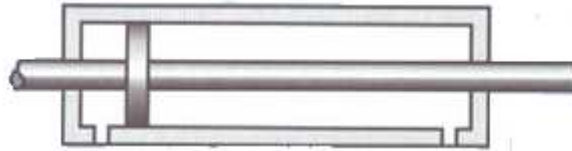
Figura 14: cilindro de doble efecto con vástago pasante FUENTE Curso de Neumática Inst. Berlín
