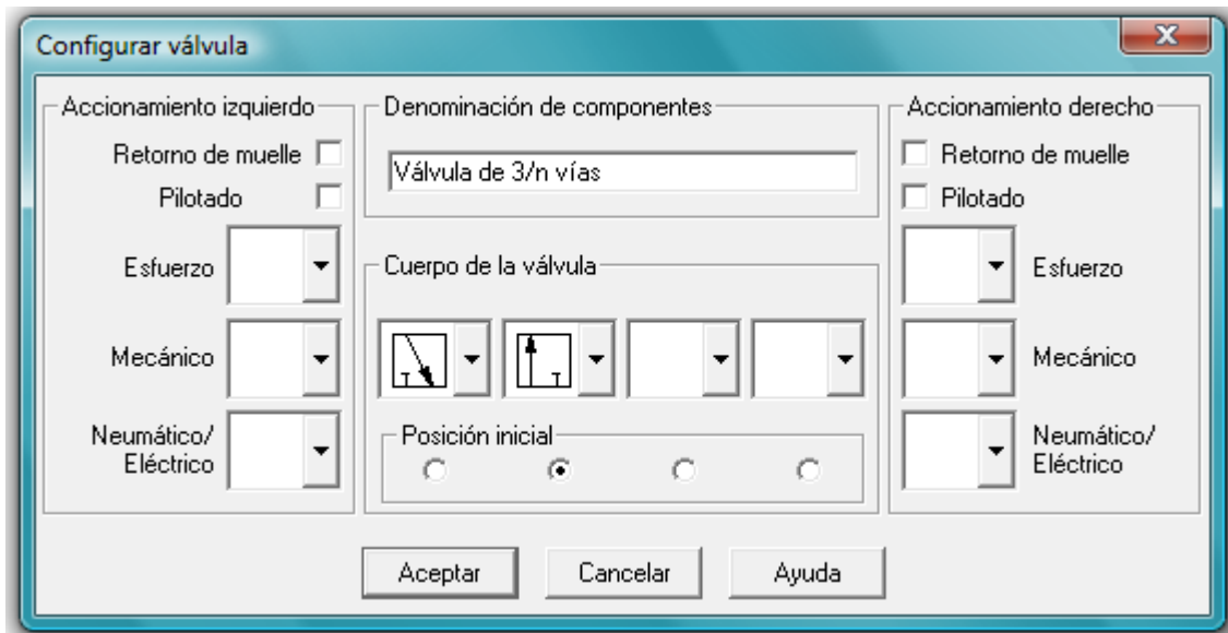
Figura 57: recuadro de válvula de mando 3/2
