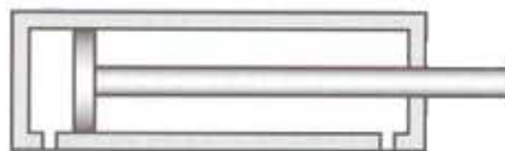
Figura 12: cilindro doble efecto FUENTE Curso de Neumática Inst. Berlín
