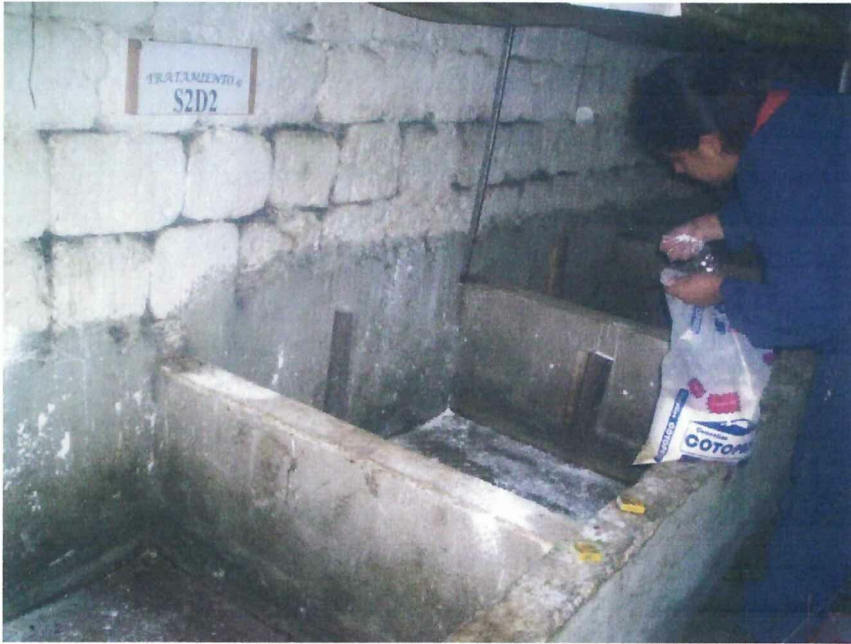
Colocación de cal en las pozas
