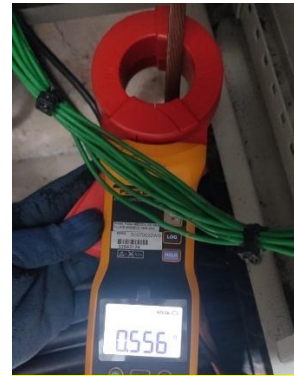
Figura 7.3. Uso de la pinza amperimétrica.
