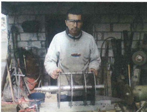
FIGURA 3.16. DISCOS UBICADOS CORRECTAMENTE EN EL EJE DEL MOLINO.
