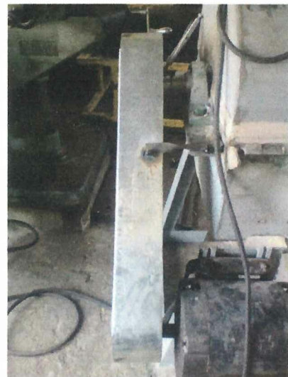
FIGURA 3.27. CARCAZA PROTECTORA DE LA BANDA INSTALADA.
