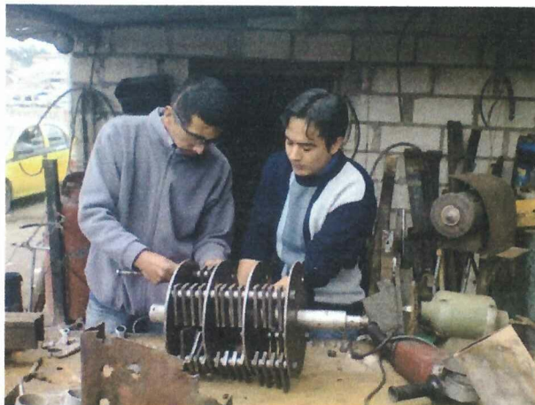
FIGURA 3.17. COLOCACIÓN DE EJE DE MARTILLOS, MARTILLOS Y BOCINES.
