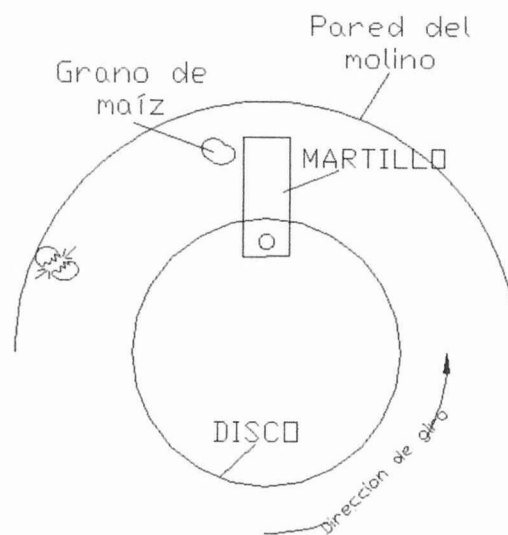
FIGURA 1.13. ESQUEMA DE CHOQUE GRANO - MARTILLO
