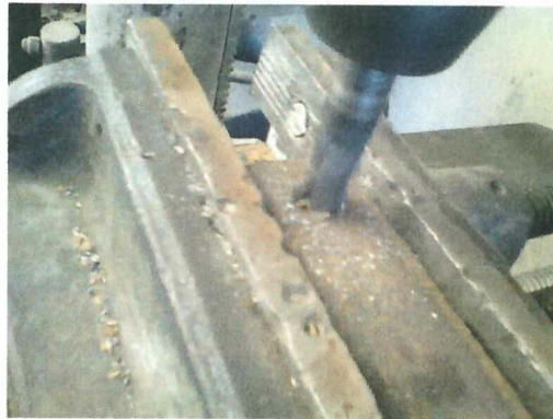
FIGURA 3.2. PERFORACIÓN DE MARTILLOS.
