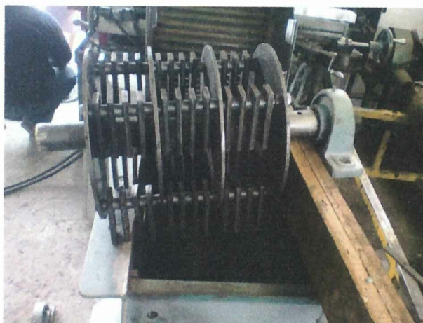
FIGURA 3.18. EJE, DISCOS, EJE DE MARTILLOS, MARTILLOS Y BOCINES ENSAMBLADOS.
