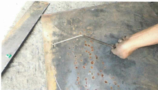
FIGURA 3.4. TRAZO DE CIRCUNFERENCIA PREVIA AL CORTE.
