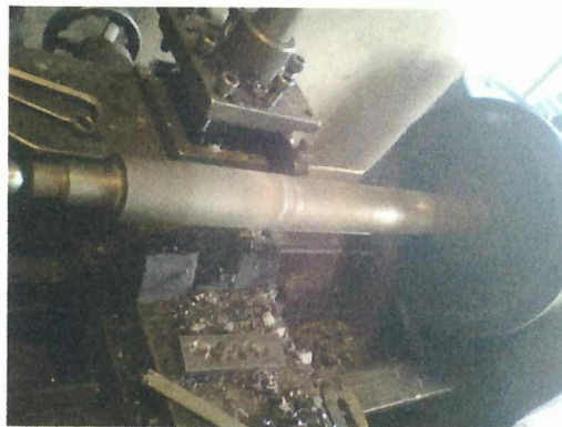
FIGURA 3.1. TORNEADO DEL EJE PRINCIPAL.
