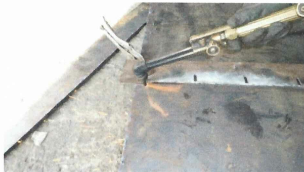
FIGURA 3.5. CORTE DE PLACAS PARA CONSTRUCCIÓN DE CÁMARA DE TRITURACIÓN.
