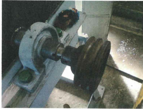
FIGURA 3.22. COLOCACIÓN DE LA POLEA EN EL EJE PRINCIPAL.
