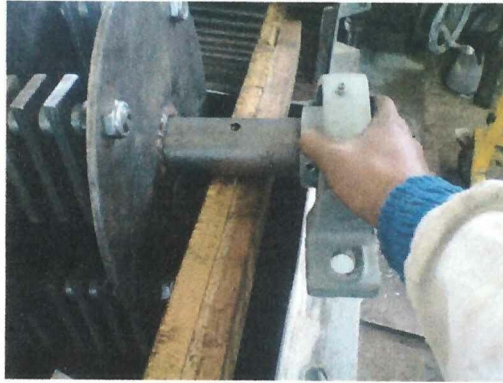
FIGURA 3.19. COLOCACIÓN DE CHUMACERAS EN EL EJE.
