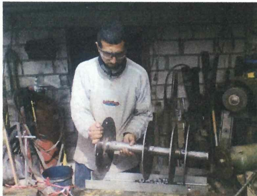
FIGURA 3.15. COLOCACIÓN DE DISCOS EN EL EJE PRINCIPAL DEL MOLINO.
