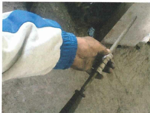
FIGURA 3.3. ALISAMIENTO INTERNO Y DE BORDES DE LOS BOCINES.
