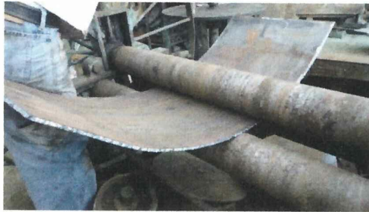
FIGURA 3.7. EMBAROLAMIENTO DE PLANCHA.
