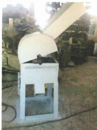
FIGURA 3.12. UNIÓN DE TAPA SUPERIOR Y PARTE INFERIOR DE LA CÁMARA DE TRITURACIÓN.
