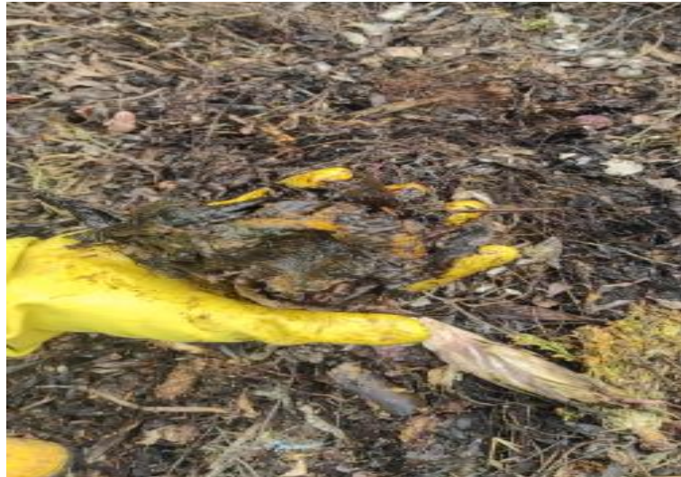
Figura 26. Fotografía de prueba del puño para verificar la humedad de la materia orgánica.
