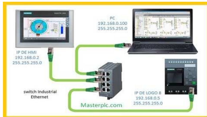
Figura 3.6. Esquema de comunicación del HMI entre el PLCs y la PC.
