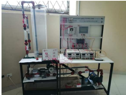
Figura 5.1. Módulo de control en cascada de nivel.
