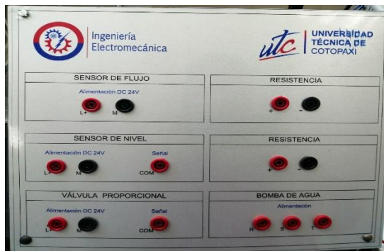
Fig. 6. Panel de conexiones
