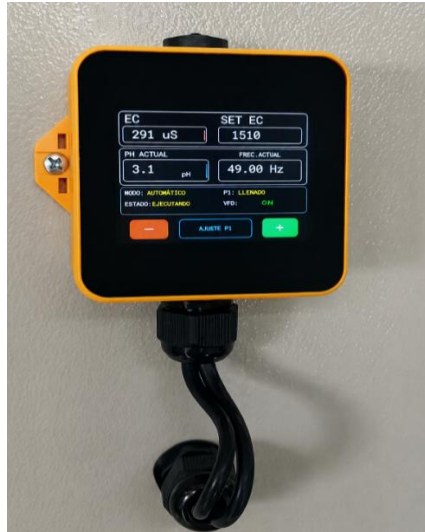
Figura 17. Interfaz de HMI
