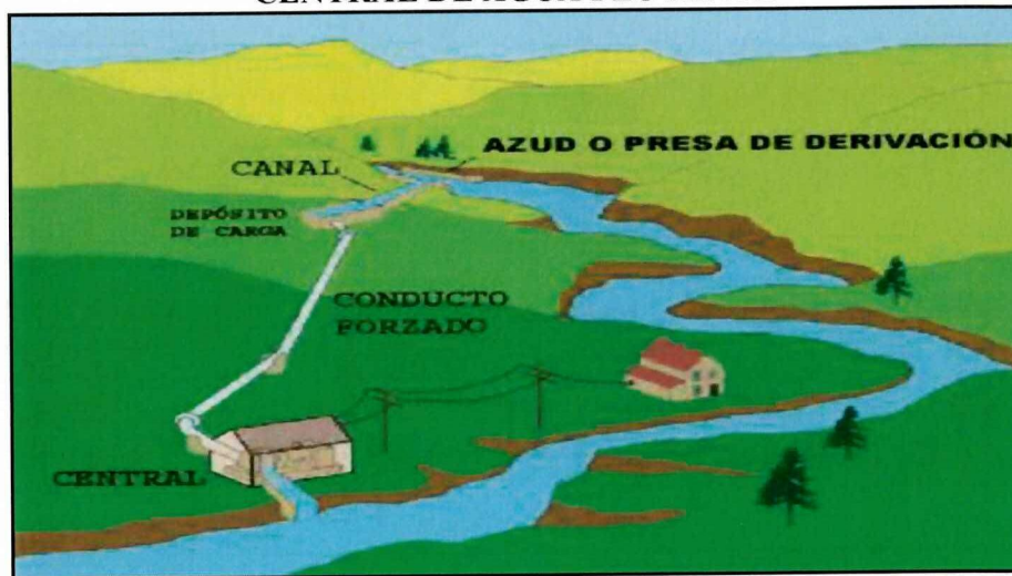
FIGURA N°1.4 “CENTRAL DE AGUA FLUYENTE”
