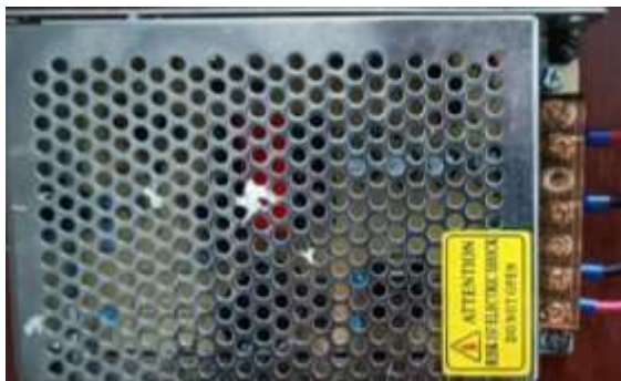
Figura 4. 6 Fuente de alimentación 24V DC
