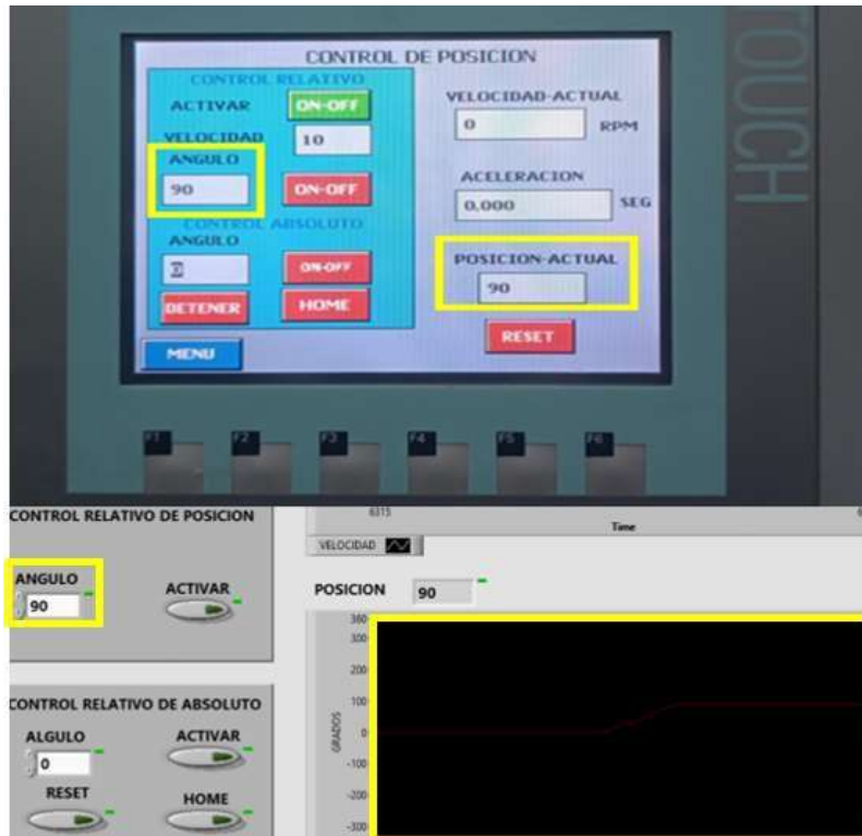
Figura 5. 11 Prueba 1 de control y posición ángulo 90°
