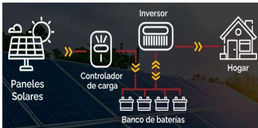
Figura. 4 Sistema fotovoltaico aislado [14].
