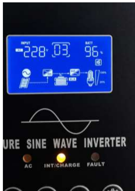
Figura. 55 Panel fotovoltaico → regulador → batería + carga + red eléctrica.
