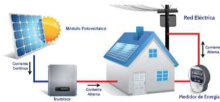
Figura. 5 Sistema fotovoltaico conectado a la red [16].
