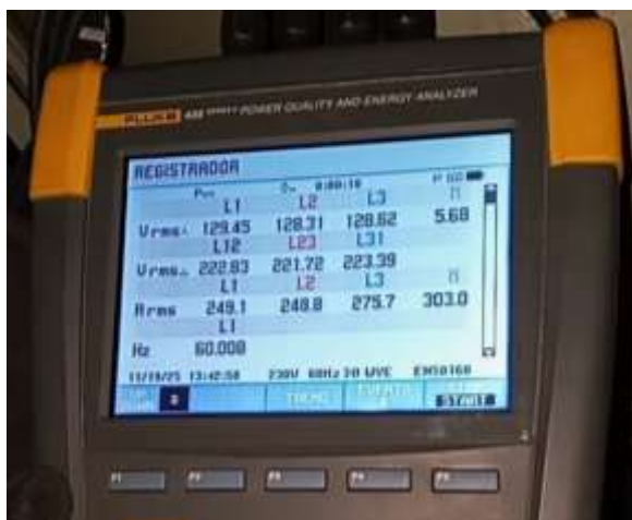
Figura. 16 Registro de datos en el analizador de red.
