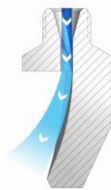
Figura 5.10. Comportamiento de boquilla FlatJet Fuente: [12]
