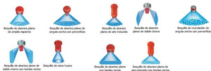
Figura 4.2. Tipo de salida de boquillas de aspersion.
