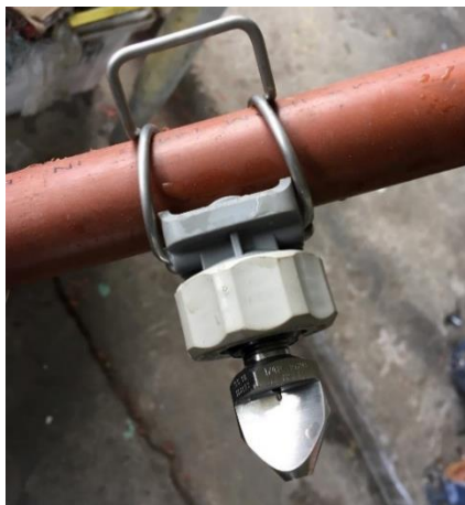
Figura 1. Boquilla la lavadora de jaulas de pollos.
