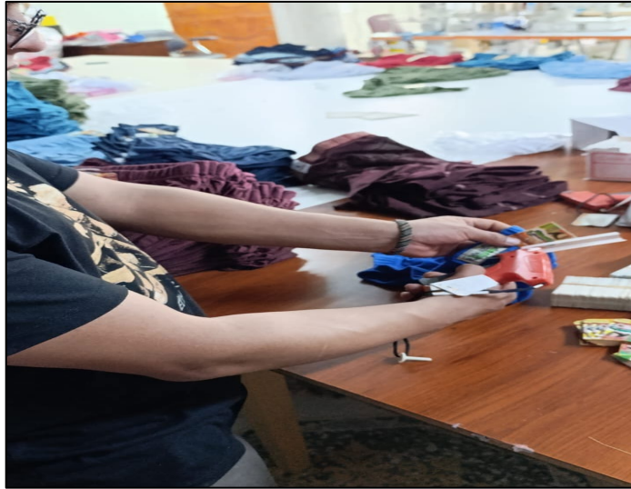
Figura 5.31. Colocación de plastiflecha del producto.
