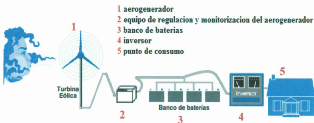
FIGURA 10. ESQUEMA DE INSTALACIÓN EÓLICA DE BAJA POTENCIA.
