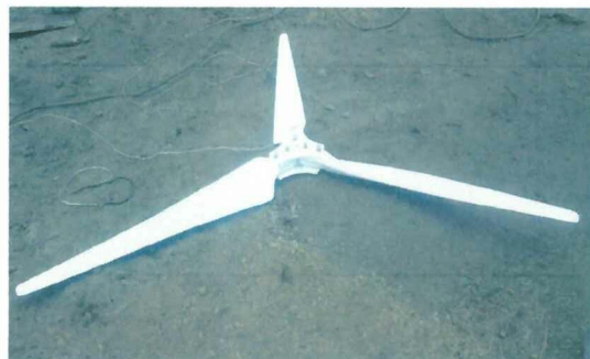
FIGURA 37. ARMADO DE LAS HELICES.
