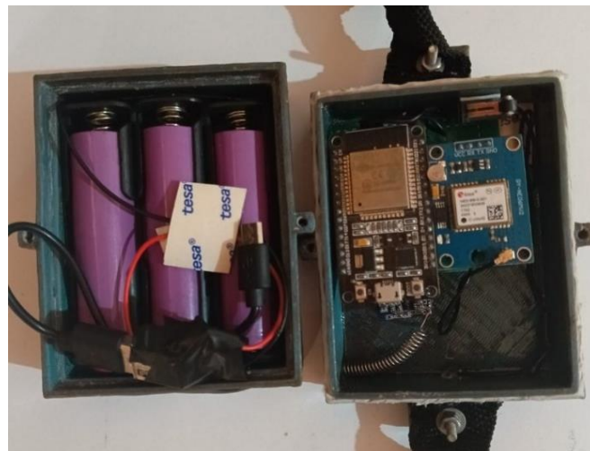
Figura 5.1 Disposición interna de los elementos del Trasmisor 01
