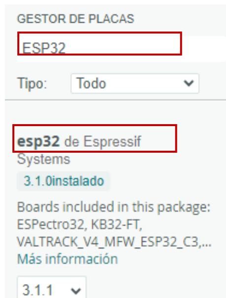
Figura 4.6. Configuración adicional para el gestor de placas ESP32
