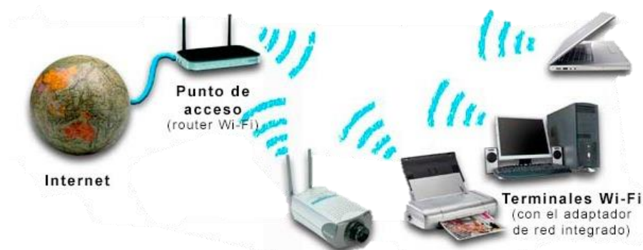
Figura 3.16. Configuración de una red inalámbrica Wi-Fi [56].
