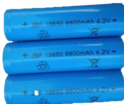
Figura 4.9. Baterías recargables usadas en el Transmisor 01
