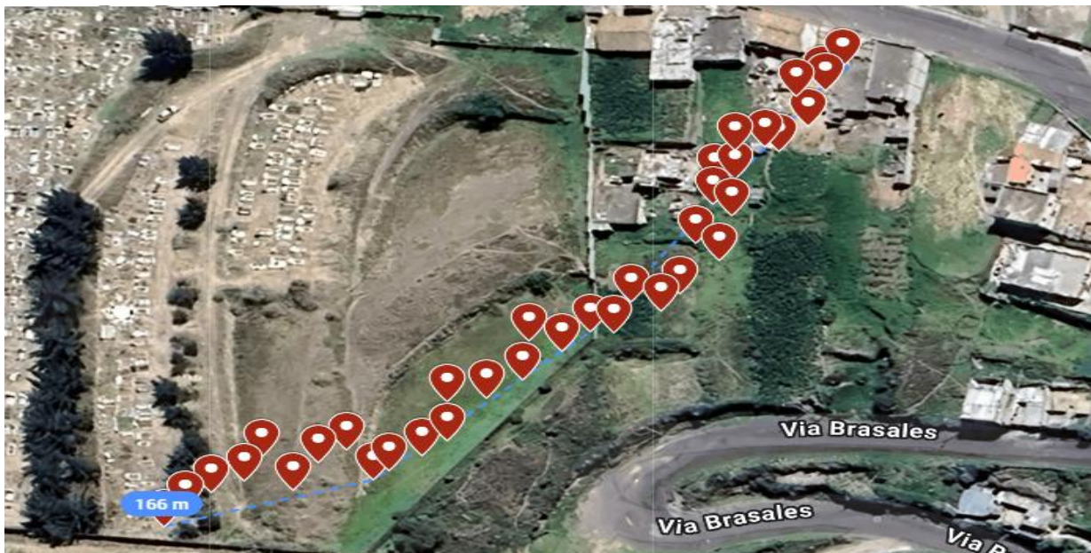
Figura 54 Distancia con antena pequeña TTGO/915 MHz “Con Obstáculo”
