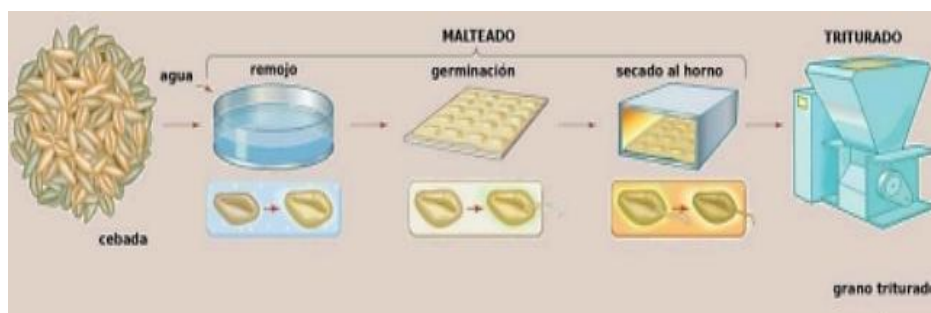
Figura 2. Proceso de Malteado
