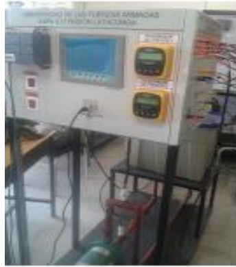
Figura 3.1. Banco de Pruebas bombas centrifugas ESPE.
