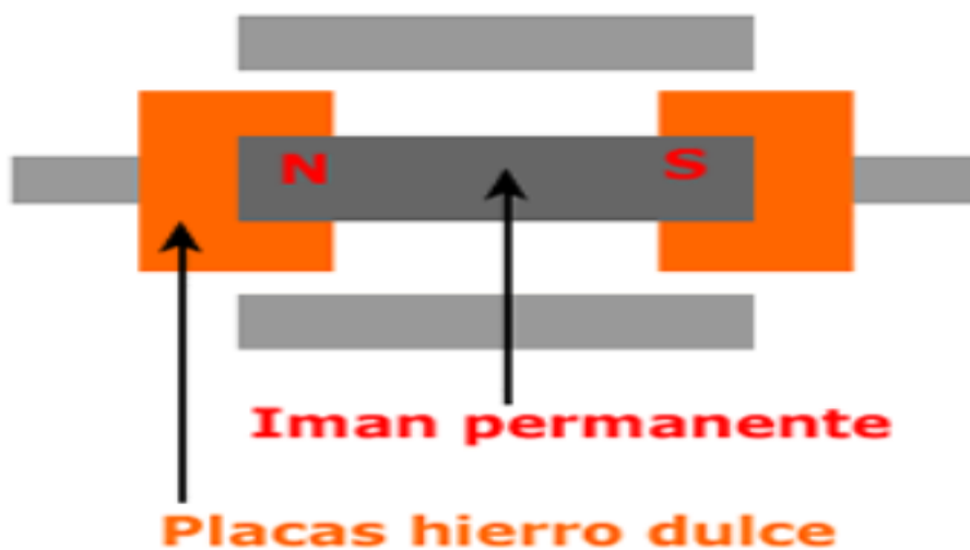
Figura 3.10. Arreglo interno de un motor a pasos híbrido
