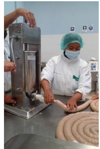
Ilustración 6.- Embutido de la mezcla homogénea.
