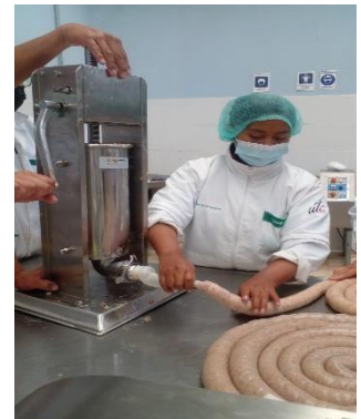
Ilustración 6.- Embutido de la mezcla homogénea.
