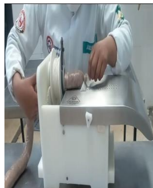
Ilustración 11.- El producto debe ingresar por parte de los rodillos hacia dentro de la amarradora.
