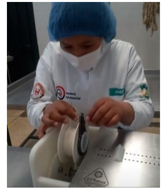
Ilustración 9.- Verificación del hilo que este correctamente.
