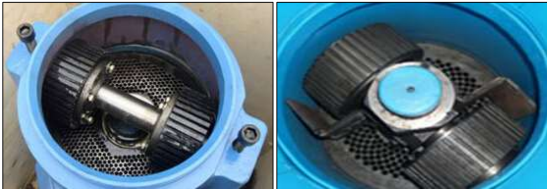
Ilustración 2 Comparación estructural entre matriz y rodillos
