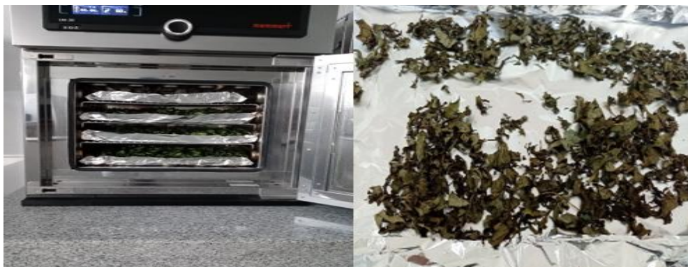
Figura 17. Deshidratado de la albahaca a 40 °C por 72 horas.
