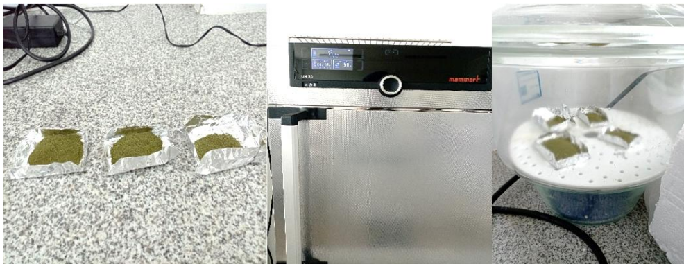
Figura 19. Determinación de humedad de la droga cruda de albahaca.
