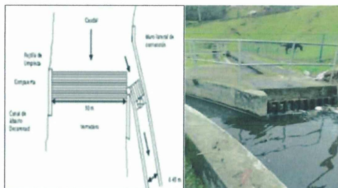
Figura 2.3 Muro lateral del desripiador
